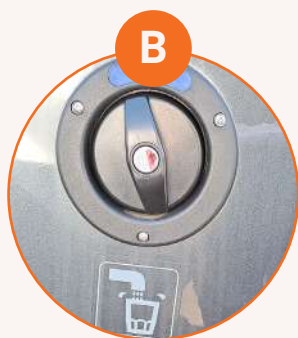
L'emplacement du remplissage du réservoir d'eau propre
